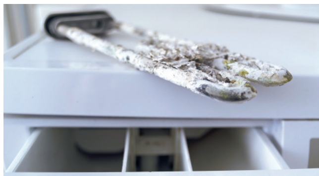
Kalkstein auf dem Heizstab einer Waschmaschine führt nicht nur zu häufigen Sanitärwartungen sondern erhöht auch den Stromverbrauch.
