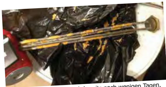
Kalkablagerungen lösen sich bereits nach wenigen Tagen.
