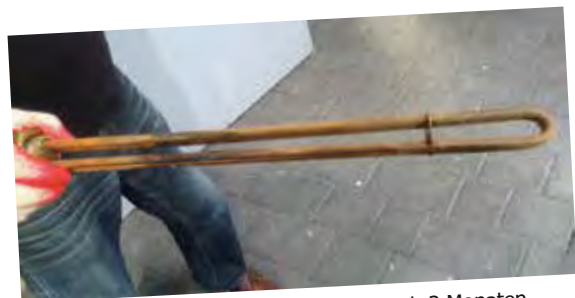
Kalkablagerungen vollständig entfernt nach 3 Monaten.
